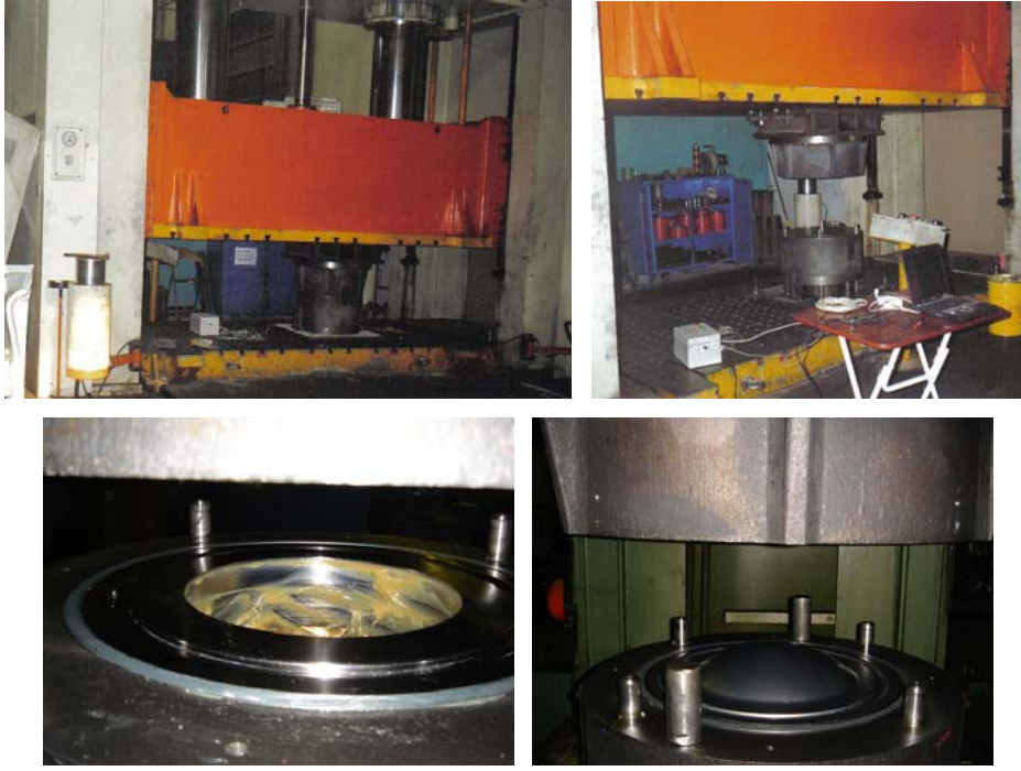
Şekil 9. Viskoz basınç ile sac şişirme deneylerinin yürütüldüğü düzenek [5]
