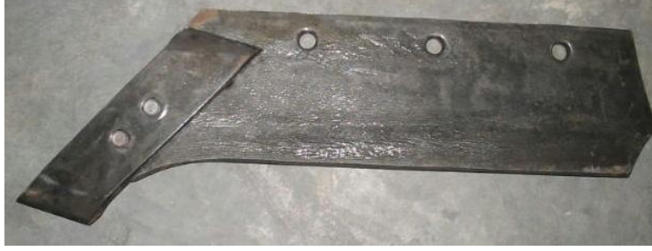
Şekil 16. Analiz sonuçlarına göre pulluk uç demirinde yapılan konstrüktif imalat değişikliği
