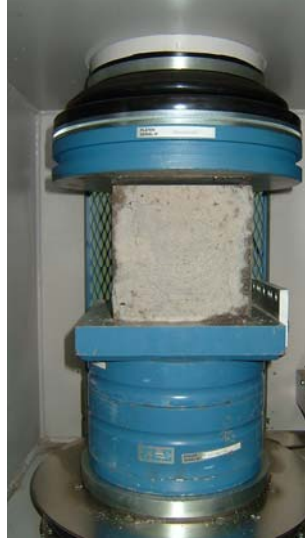
Şekil 2. Numunelerin tek eksenli basınç yüklemesine tabi tutulması.
