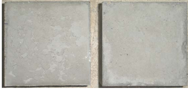
Şekil 3. Görüntü işleme tekniği ile gözeneklik durumu belirlenecek olan sırasıyla katkısız ve katkılı numuneler.
