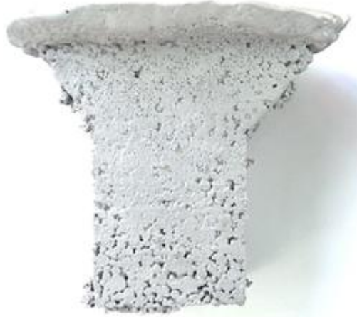
Şekil 1. Dolu Kalıba Döküm Yöntemi Kullanılarak Dökülen Parça
