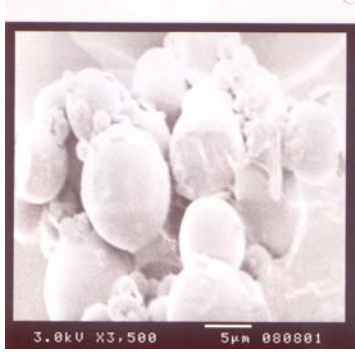
Şekil 3. EGDM-sodyum akrilat esaslı kopolimerin SEM mikrografı
