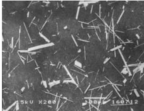
Şekil 3.6. 300.dakikada oluşan \text{CaSO}_4 \cdot 2\text{H}_2\text{O} kristalleri
