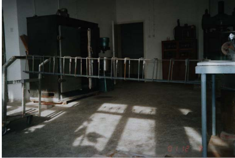
Fotoğraf 1. Referans kirişin donatısının bağlanması
