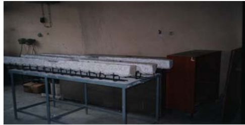
Fotoğraf 2. Alttan U şeklinde etriyenin ankrajı
